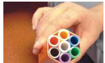
Foto: So sehen die Leerrohr-Bündel aus, die eingelegt werden. Hier werden später die Glasfaserleitungen eingeblasen. © Gemeinde
